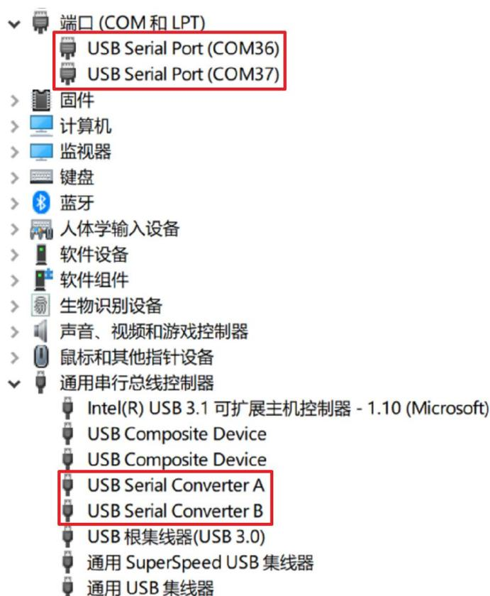
图 8-7 设备管理器中显示两个串口
